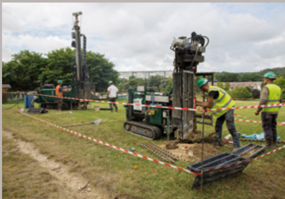
Sondage des sols en préparation des travaux de la Médiathèque
